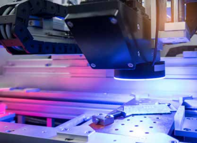
金属冲压件 3D 表面检测
