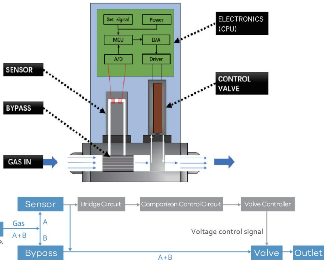
质量流量控制器由流量传感器、分流器、通道、流量调节阀和控制电路等部件组成，结构如上图所示。气体通过质量流量控制器（简称MFC）时，大部分气体通过层流元件，成比例的部分气体通过流量传感器。采用恒温差方案的热式传感器将流量信号转换为电信号，以此为基准测量当前通过MFC的气体流量大小。微控制器比较设定信号与实际流量信号的差值，并驱动压电陶瓷，实时动态的调整当前流量大小，以达到理想的设定值。质量流量控制器的流量控制范围是(2~100)% F.S.
